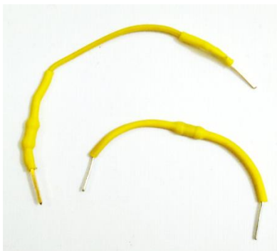
Abbildung 26: Kabel mit angelötetem Widerstand (oben) und Widerstand mit Schrumpfschlauch (unten)
